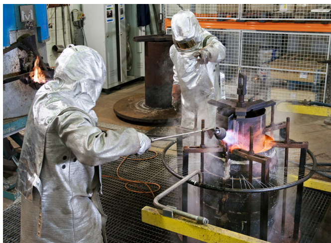
Opération de réglage : coulage d'une couche de matériaux antifriction (le régule) sur des pièces fixes (paliers, patins, joints) des turboalternateurs hydroélectriques.
